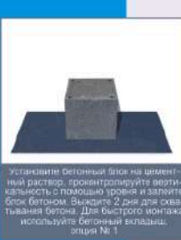
На подготовленную цементную стяжку (фундамент) нанесите гидроизоляционную пленку (например, битум), затем нанесите цементный раствор марки М150. Работы с раствором ведите только при температуре выше 0°C
