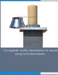
Смонтируйте окрышечную плиту на блок цементным раствором, место соединения с плиткой уплотняется силиконовым герметиком
