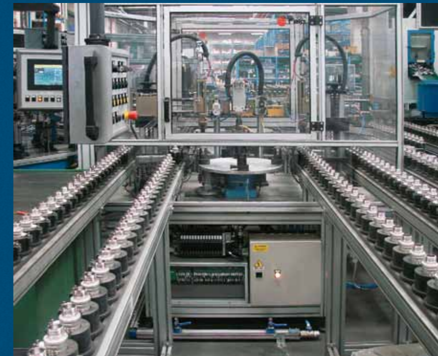
Автоматизированная линия производства шаровых кранов на заводе компании Bugatti Valvosanitaria.
